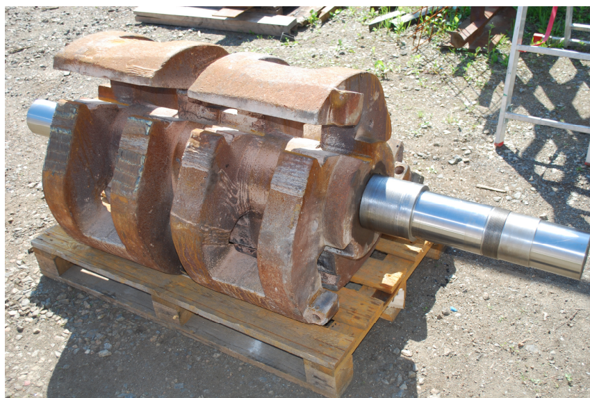
Oprava hřídele. Svařování a navařování rotoru.
