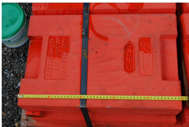
Před opotřebením (80x320x500, 88 kg)
